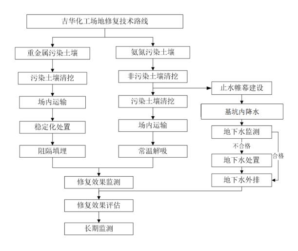
图 5-1 原吉华化工场地土壤修复技术路线
