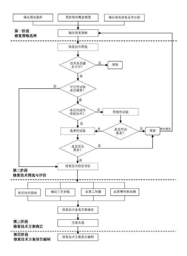
图 1-2 蓟州区原吉华化工厂场地修复方案编制工作程序
