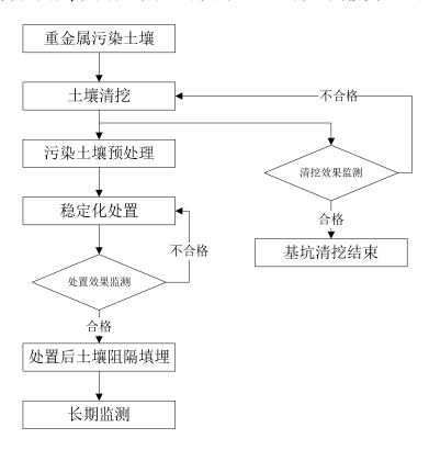
图 5-2 污染土壤固化/稳定化修复工艺流程示意图
