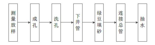
图 7-13 基坑降排水工艺流程
